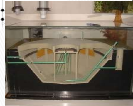
Figura 1– Ilustração de um reator UASB em perfil Fonte: Aisse (2000) citando Sanepar
