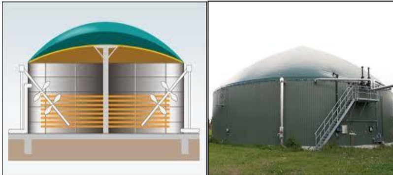
Sistema tipo CSTR – reator de tanque de agitação contínua Aplicação: resíduos em geral, agrícolas
