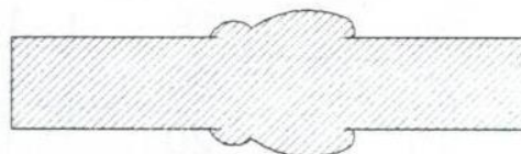
Solda Ruim (materiais com tempe- raturas diferentes)
