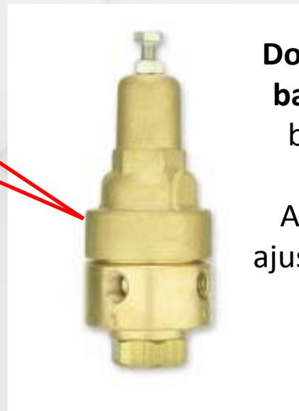
**Dois Pilotos redutores, de alta e baixa pressão**, completamente balanceados, asseguram alta precisão e estabilidade. Através de seus parafusos são ajustadas as pressões para o dia e para a noite.
