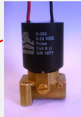
**Solenóide tipo Pulso**, não necessita ficar energizada durante o tempo de acionamento, basta um pulso para que abra e um pulso para que feche, proporcionando assim baixo consumo de energia.
