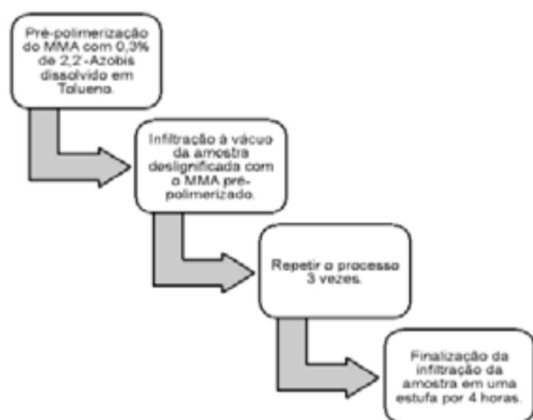
Figura 4 - Fabricação da Madeira Óptica Transparente.
