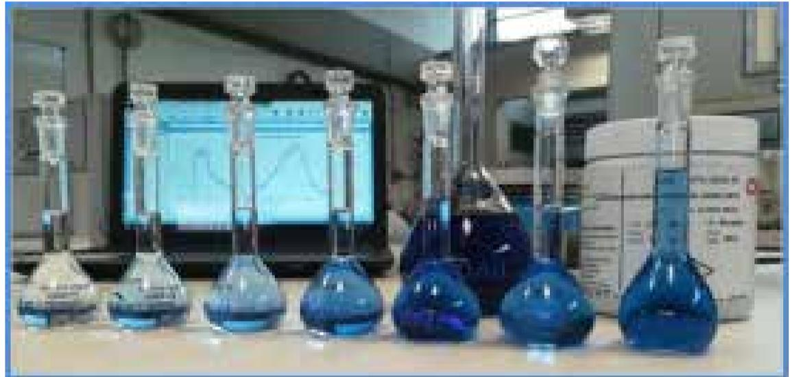
As leituras das amostras acima citadas foram realizadas no comprimento de onda de 605 nm e uma curva de concentração versus absorvância (Figura 7) foi plotada, gerando assim a equação utilizada para o cálculo das concentrações durante o período de ensaios e análises dos processos de catálise e de fotocatalise, conforme a Equação 11.
